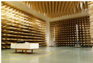
電磁波測定に使用する電波暗室
