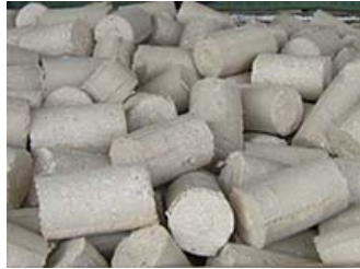
ピアノ製造工程から排出された木粉をペレット化して作られた「木粉ブリケット」
