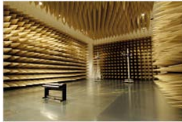
電磁波測定に使用する電波暗室
