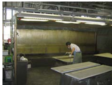
湿式塗装ブース（掛川工場）
