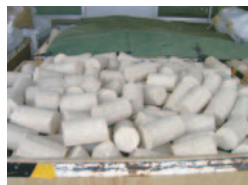
ピアノの製造工程から排出された木粉をペレット化して作られた「木粉ブリケット」
